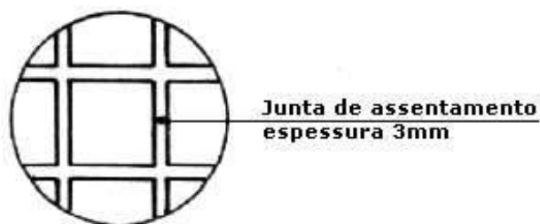
Foto 11 - Ilustração da junta de assentamento dos revestimentos cerâmicos.
